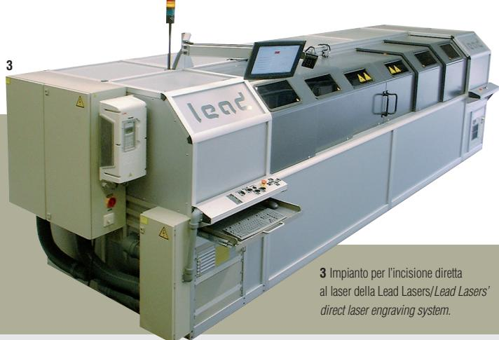
3 Impianto per l'incisione diretta al laser della Lead Lasers/Lead Lasers' direct laser engraving system.
